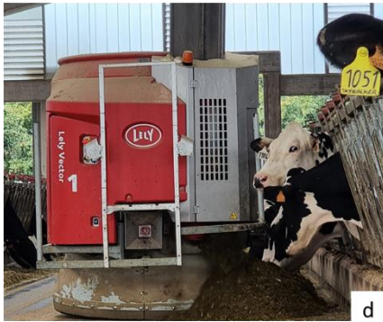
Figura 3: Differenti tipologie costruttive del vagone di un'AFS: a) sospeso solo distributore; b) guidato miscelatore-distributore; c) sospeso miscelatore-distributore; d,e,f) semovente miscelatore-distributore (le immagini, scattate dagli autori, sono un esempio della tecnologia rappresentata, non intendono essere in alcun modo un endorsemen della marca e del modello impiegato in stalla)
