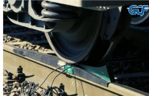
Misura statica del peso di alcuni vagoni di prova
